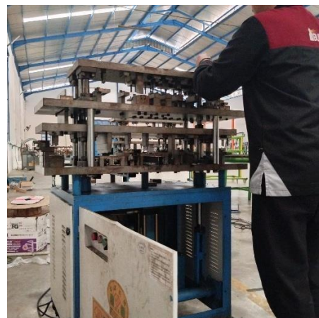
Gambar 6. Dies sebagai cetakan/tumpuan material kerja
