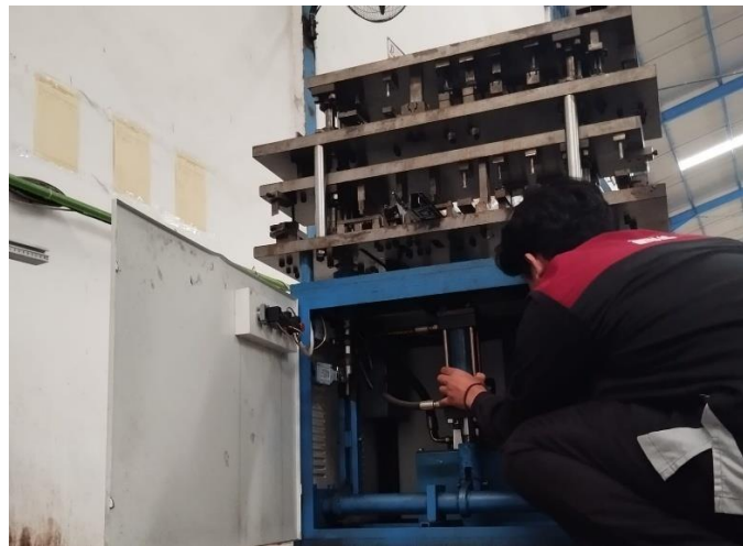
Gambar 3. Lengan hidrolik / aktuator pada mesin punch
