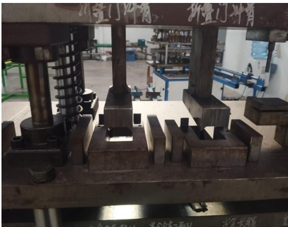
Gambar 6. Dies sebagai cetakan/tumpuan material kerja
