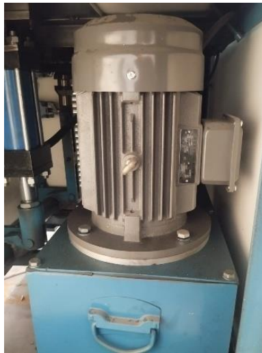
Gambar 1. Motor listrik 3 fasa sebagai penggerak pompa hidrolik
