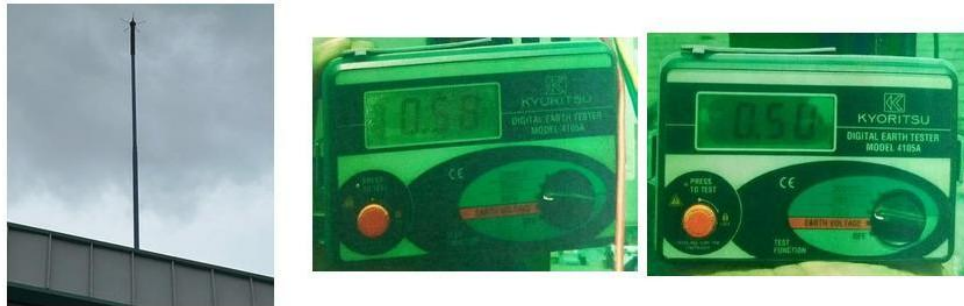
Gambar 5. Terminal penyalur petir elektrostatik dan hasil pengukuran resistansi pentanahan pada titik 1 (0,58 \Omega ) dan titik 2 (0,50 \Omega )
