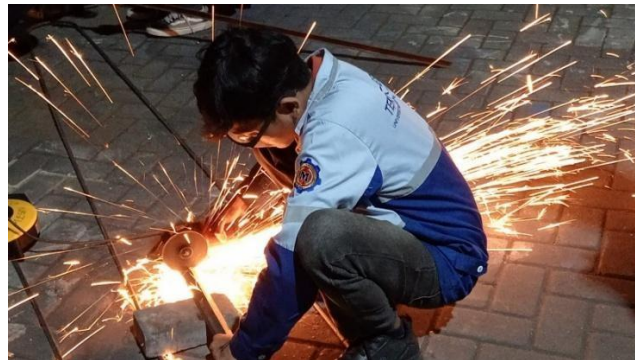
Gambar 4. Proses pemotongan bahan menggunakan mesin gerindra potong
