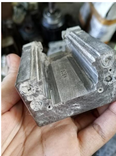
Gambar 4. Jalur Bola Bearing Terkena Cat
