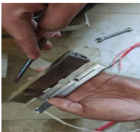
Gambar 4. Pengantian heater pada mesin pengemas teh
