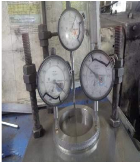
Gambar 8. Hasil Pengukuran Lebih dari Toleransi
