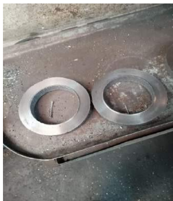
Gambar 7. Material Sesudah Diproses Diameter Dalam
