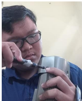
Gambar 2. Perawatan motor listrik pada mesin CNC UPT Industri logam dan perekayasa Sidoarjo
