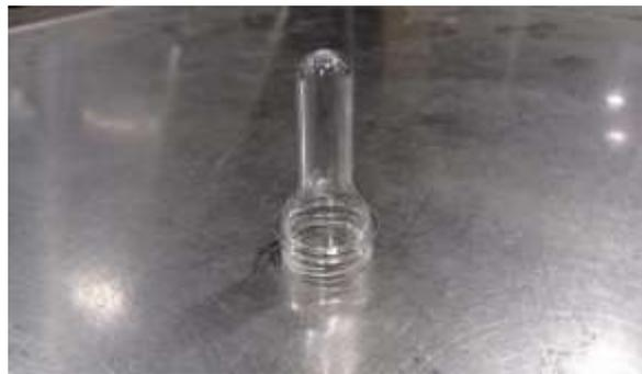
Gambar 4 Material Pembuatan Botol (*preform* AMDK 330ml)
