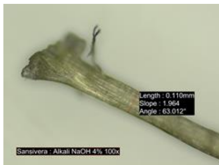
Gambar 8. Serat dengan perlakuan alkali NaOH 4%
